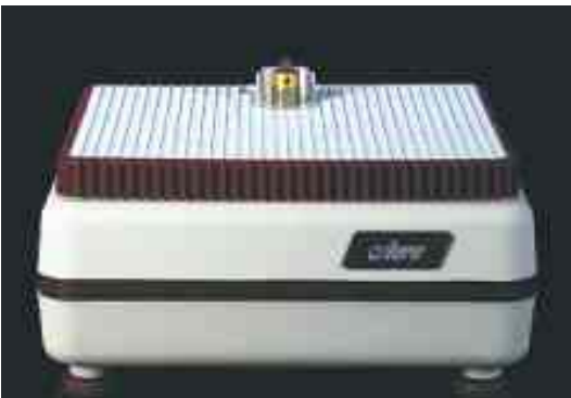
30 116 00 INLAND AERO 230 x 255 mm Arbeitsfläche / work surface (beidseitig verwendbar / double sided), 3450 U/min, Thermoschutz / thermal protection, incl. 19 mm Schleifkopf / bit, TouchTop - Schalter / switch
